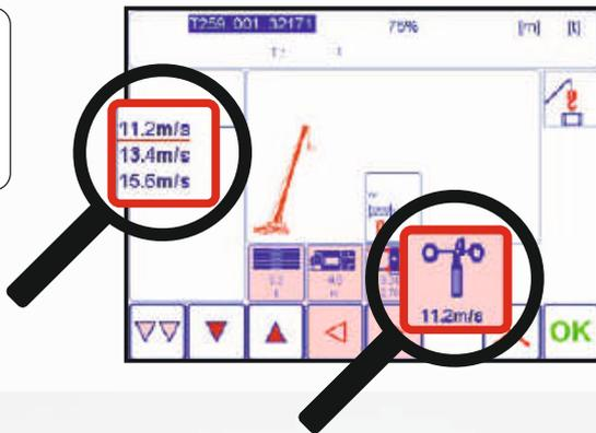
Erhöhte Flexibilität und Sicherheit durch Traglasttabellen mit unterschiedlichen zulässigen Windgeschwindigkeiten.
